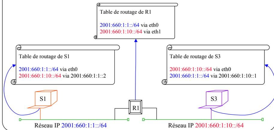
Sur une machine Linux, la table de routage peut se voir avec la commande `netstat` (ou avec la commande `'ip route'`), exemple pour la machine S1 (table de routage IPv4 puis IPv6):
