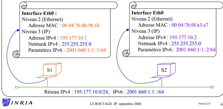
Sur une machine Linux, la configuration de l'interface eth0 se voit avec la commande ifconfig (ou avec la comande ' ip addr '), exemple pour la machine S1 :
