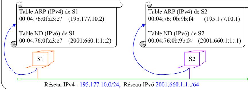
Sur une machine Linux, la table arp (pour IPv4) peut se voir avec la commande arp, exemple pour la machine S1 (après le ping une nouvelle entrée est créée, elle correspondant à la machine s2) :
