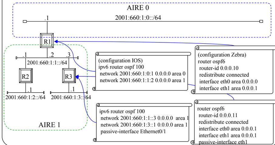
C'est la directive *network* qui permet de positionner une interface dans une aire donnée.
