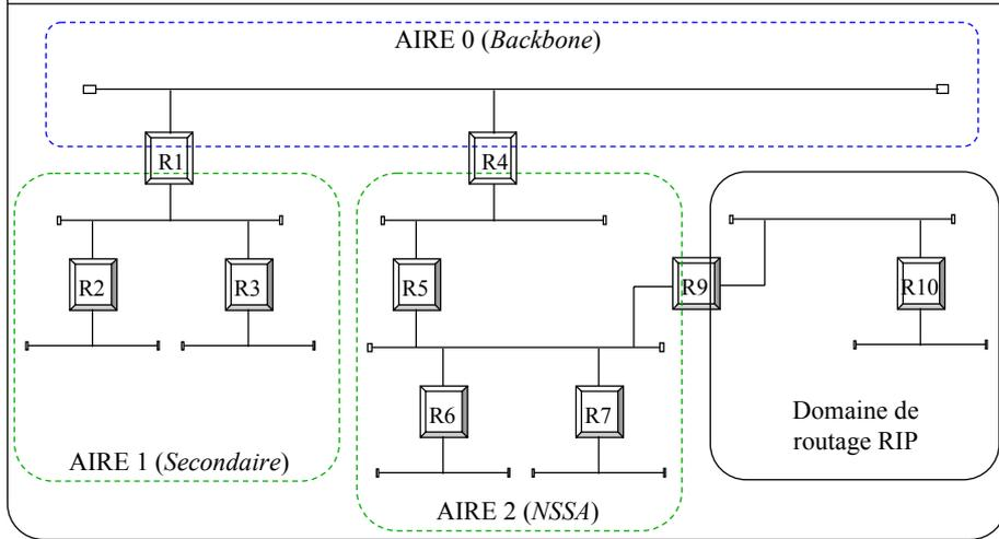
L'aire 2 est de type NSSA (Not So Stuby Area). C'est une aire terminale 'améliorée' pour permettre l'injection des routes que le routeur R9 va apprendre du domaine de routage RIP.
