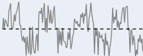
Le bruit fixe la **limite inférieure** du niveau des signaux que peut traiter un composant.
