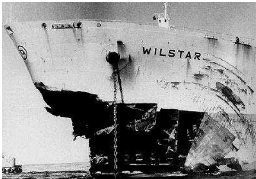
Etrave détruite par une vague scélérate.
