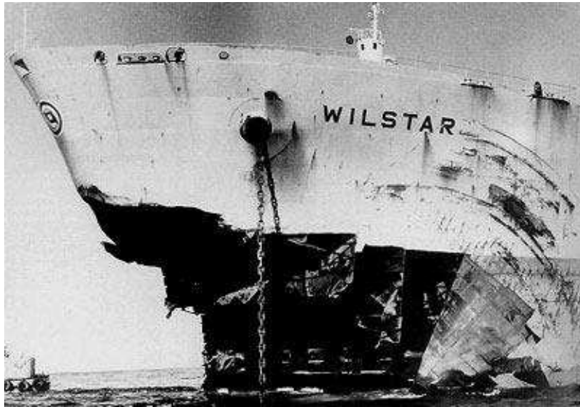
Etrave détruite par une vague scélérate.
