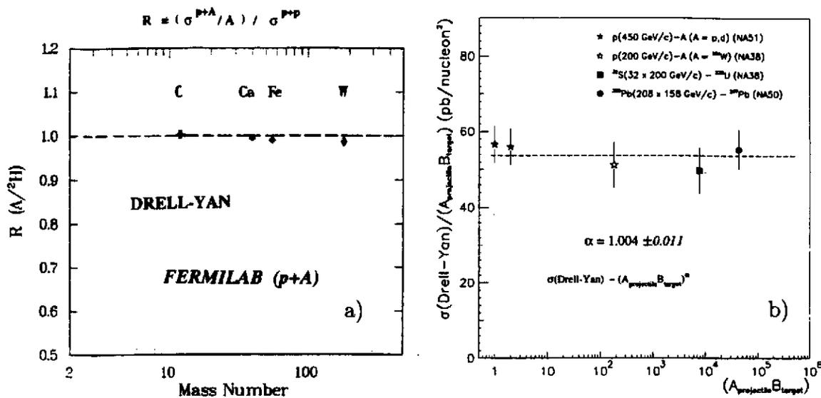
Figure 4: Sections efficaces "réduites" Drell-Yan obtenues au Fermilab (a) et CERN-SPS (b)
