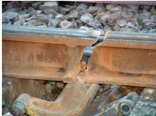
FIGURE 2.11 – Rupture d'un rail sur la ligne D du RER, de au gel en Octobre 2003
