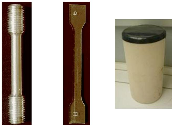
FIGURE 2.1 – Eprouvettes utilisées dans des essais uni-axiaux : à gauche et au milieu, éprouvette cylindrique et éprouvette plate pour un essai de traction ; à droite, éprouvette cylindrique pour un essai de compression.
