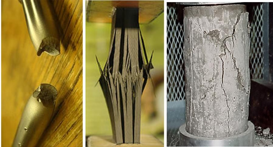
FIGURE 2.6 – Etat final de différentes éprouvettes après un essai uniaxial : à gauche, rupture par striction d’une éprouvette métallique ; au centre, rupture par décohesion des fibres d’un composite à fibres de carbone ; à droite, rupture par fissuration longitudinale d’une éprouvette de béton comprimée.
