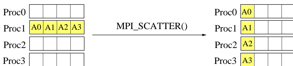
FIG. 5: Fonction MPI_SCATTER (). Le processus Proc1 diffuse ses données A_0, \dots, A_3 (stockées dans sa mémoire) à tous les processus Proc0 à Proc3 de façon répartie.
