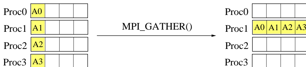
FIG. 6: Fonction MPI_GATHER (). Le processus Proc1 collecte les données A_0, \dots, A_3 provenant des processus Proc0 à Proc3 .
