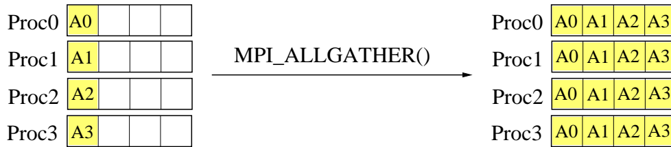
FIG. 8: Fonction MPI\_ALLGATHER() . Le processus Proc1 collecte les données A0, \dots, A3 provenant des processus Proc0 à Proc3 et le diffuse à tous les processus.
