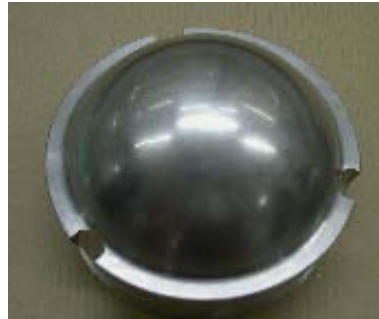
Figure 9 : Fenêtre en T91 de la cible du projet MEGAPIE [27].
