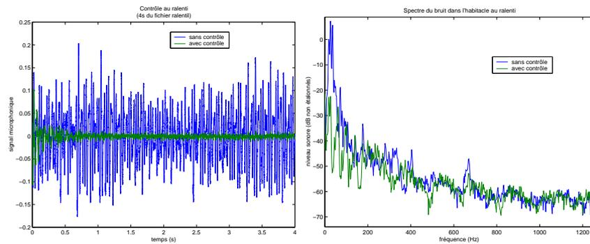
FIG. 3.1 – Contrôle actif du bruit moteur au ralenti
