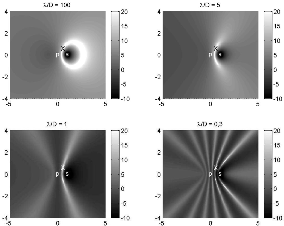
FIG. 1.1 – Atténuation (en dB) obtenue par contrôle avec un monopôle secondaire (s) du bruit produit en un point (X) par un monopôle primaire (p)
