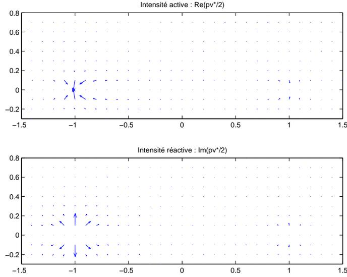
FIG. 1.3 – Intensité acoustique après contrôle pour  $\lambda/D = 10$
