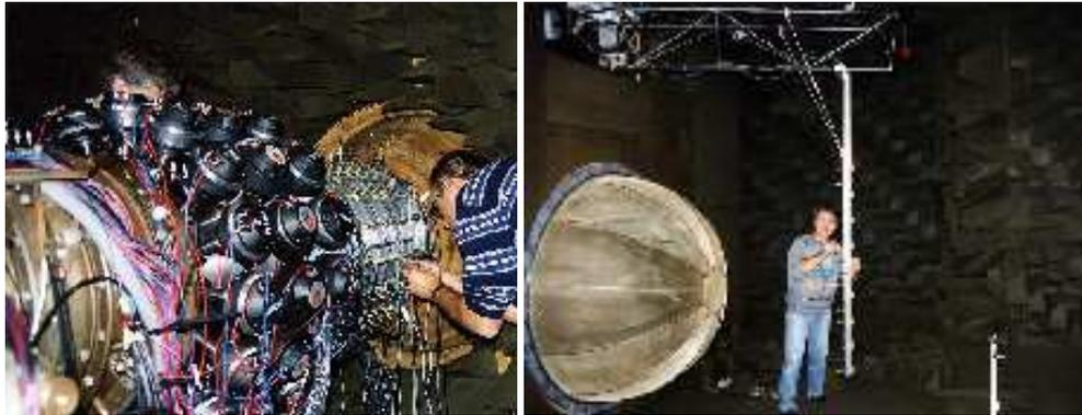
FIG. 3.7 – Le banc d’essai du bruit de soufflante
