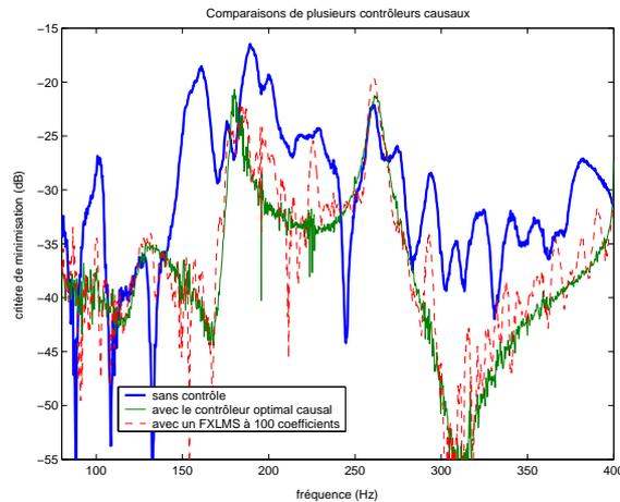
FIG. 2.6 – Contrôle optimal vs. contrôle FXLMS
