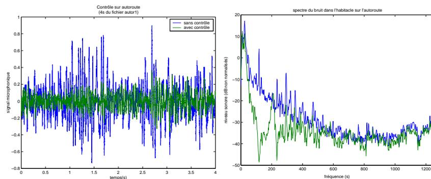
FIG. 3.2 – Contrôle actif du bruit moteur sur autoroute
