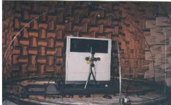
FIG. 3.11 – Un transformateur de puissance en chambre anéchoïque
